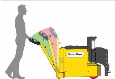
Automatische Abschaltung bei vertikaler Deichselstellung
