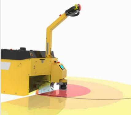
Profitieren Sie vom autonomen Einsatz unserer Elektroschlepper und machen Sie die Steuerung durch einen Bediener überflüssig. Durch die Nutzung einer Linie auf dem Boden, kann sich Ihr Elektroschlepper autonom zwischen einzelnen Stationen bewegen.
