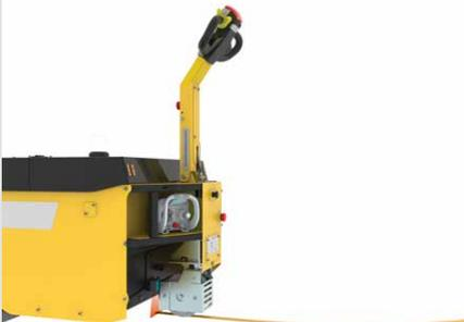
Wireless AutoSteer kombiniert die Vorteile von Fernsteuerung und Linienführung. Mit Wireless AutoSteer folgt der Elektroschlepper einer vordefinierten Route, die durch eine Linie auf dem Boden markiert ist, wobei der Fahrer die Geschwindigkeit kontrolliert.
